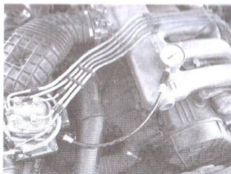
Fig. 4.3. Măsurarea debitului și presiunii pompei de alimentare neimersate: a – amplasarea manometrului pe motor; b – trusă pentru măsurarea presiunii combustibilului
