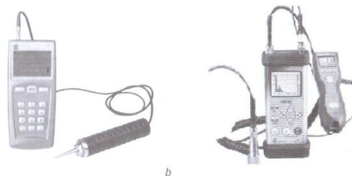
Fig. 3.5. a – Modul de măsurare a vibrațiilor; b – tipuri de vibrografe
