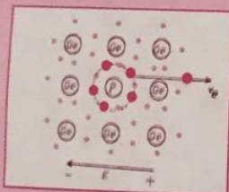
Fig. 14.2. Cristal de germaniu impurificat cu fosfor
