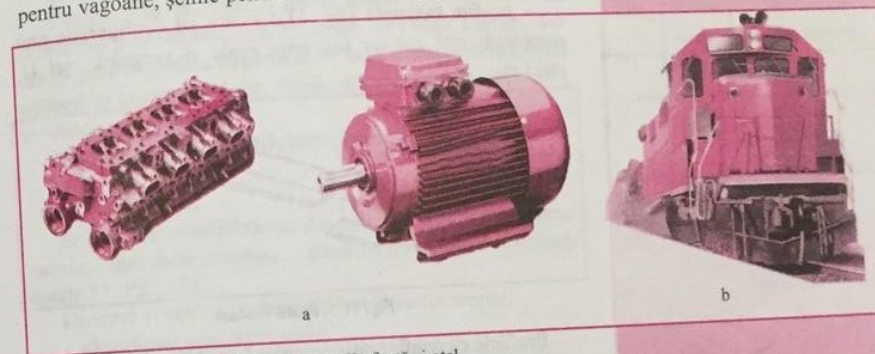
Fig. 11.2. Piese turnate din fontă și oțel
