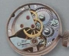
6 Mecanism de ceasornic cu elemente de alamă
