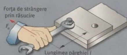
1 Momentul de torsiune cu un exemplu de calcul
