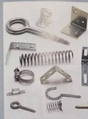
5 Elemente deformare plastică
