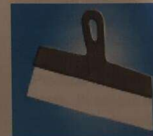
Fig. 3.32. Șpaclul lat (lățimea 200, 250 și 300 mm) se folosește pentru aplicarea gletului la finisare.
