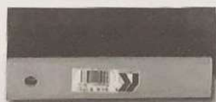
Șpaclu de cauciuc servește la netezirea rosturilor între plăcile de ceramică
