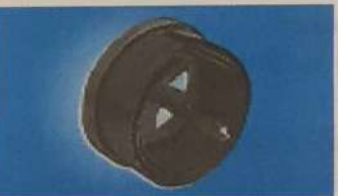
Fig. 3.24. Freză ciclică „Lohsage”. Se utilizează pentru debitarea golurilor în plăcile Knauf cu diametrul 60 (67, 74), 72 (80, 95) mm. Se montează pe mașina de înfiletat.
