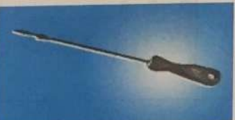
Fig. 3.23. Ferăstrău de traforaj „Stichiling”. Se aplică pentru decuparea precisă a suprafețelor de dimensiuni reduse.
