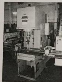
Fig. 3.5. Presă pentru îndreptat profiluri: a. schema de lucru; b. mașina de îndreptat; 1. suport; 2. berbec; 3. profil de îndreptat.
