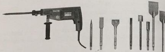
Fig. 3.12. Ciocan pneumatic pentru dălțuit: a. ciocan pneumatic; b. dălți pentru ciocanul pneumatic.
