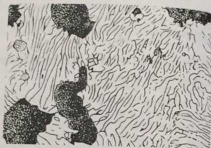
Fig. 7.9. Fontă maleabilă cu miez alb (perlită și grafit).
