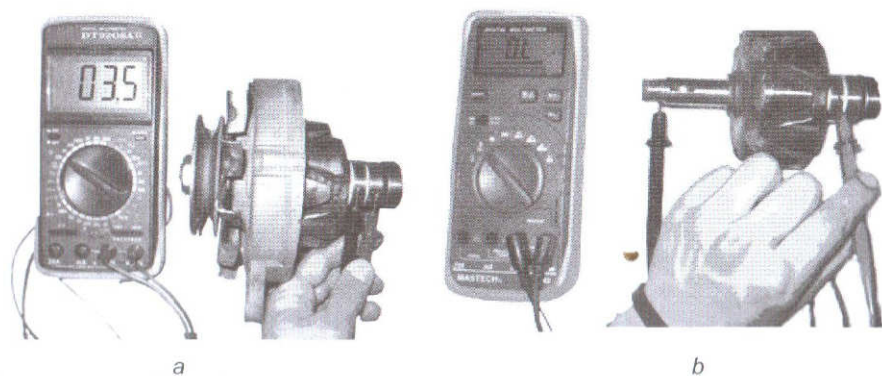
Fig. 7.23: a – Montajul și conexiunile electrice pentru măsurarea rezistenței electrice a alternatorului; b – montajul pentru măsurarea izolației colectorului
