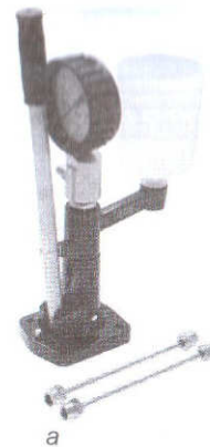
Fig. 4.6: a – Stand pentru verificarea injectoarelor; b – montajul pentru verificarea injectoarelor
