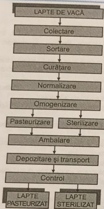
Fig. 2.21. Schema procesului tehnologic de obținere a laptelui de consum.
