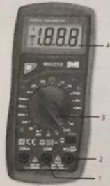
1 - bornă comună COM; 2 - borna (priza) A pentru folosirea ampermetrului; 3 - selector de funcții și domenii; 4 - afișarea cu cristale (LED). Fig. 6.15. Multimetrul digital
