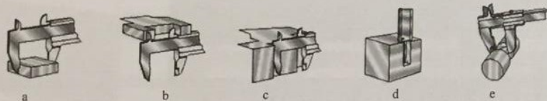
Fig. 3.5. Tipuri de suprafețe care pot fi măsurate cu șublerul: a. - suprafețe exterioare; b. - suprafețe interioare; c. - grosimi; d. - adâncimi; e. - gătuiri.
