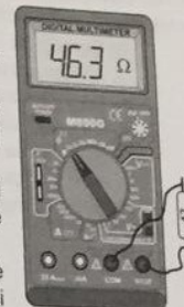
Fig. 6.34. Măsurarea rezistenței electrice cu multimetrul digital
