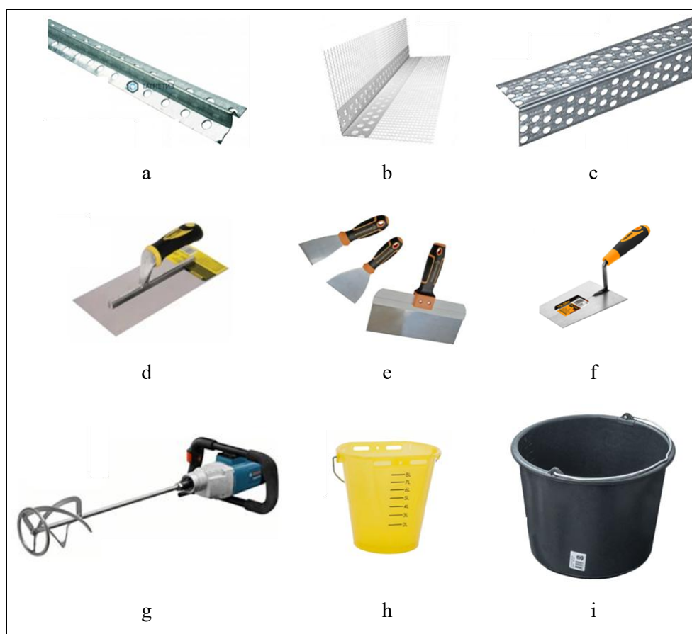
Fig. 43. Instrumente pentru tencuirea cu amestec uscat: a – șină de ghidaj; b – colțar cu plasă; c – colțar; d – gletieră; e – spatule; f – mistrie; g – malaxor; h – vas gradat; i – vas pentru mortar
