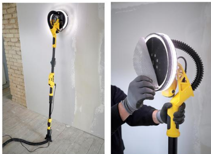
Fig. 61. Mașină de șlefuit suprafețele tencuite
