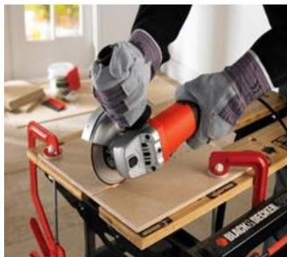
Fig. 13. Tăierea plăcilor cu flexul
