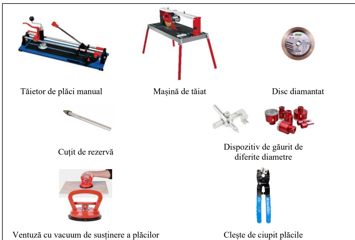
Fig. 1. Instrumente și dispozitive de tăiat și de găurit plăcile
