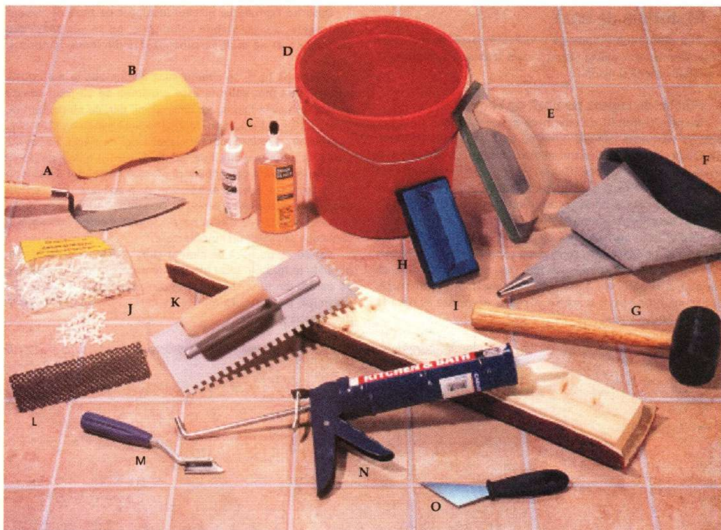
A – mistrie; B – burete neabraziv; C – flacon cu sigilant pentru chit + aplicator; D – găleată; E – gletieră netedă pentru chituire; F – aplicator de chit; G – ciocan de cauciuc; H – instrument de curățare a chitului; I – bucată de scândură; J – distanțiere; K – gelatină zimțată; L – șmirghel suflat cu carborund; M – răzuitor de chit; N – pistol de silicon; O – instrument pentru îndepărtarea distanțierelor.
