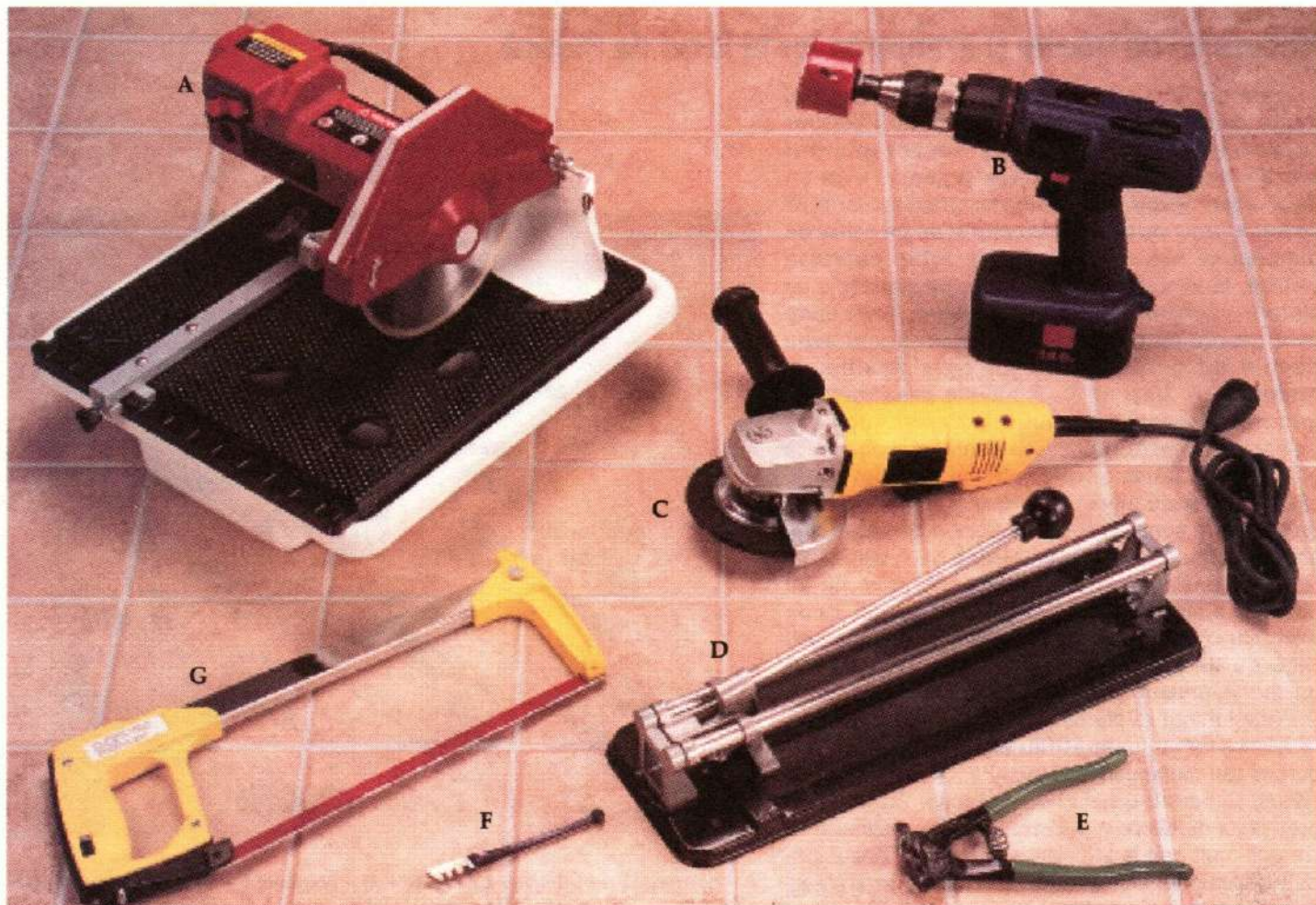
A – ferăstrău circular cu apă; B – bormașină portabilă cu acumulator prevăzută cu un miniferăstrău de decupat orificii; C – flex cu disc de carborund; D – mașină manuală de tăiat plăcile ceramice, cu mâner; E – clește pentru gresie și faianță; F – cutter pentru sticlă; G – ferăstrău manual cu lamă cu carborund.
