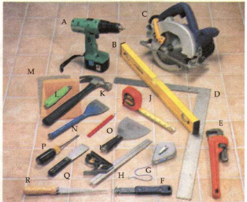
A – bormașină portabilă cu acumulator; B – boloboc; C – ferăstrău circular; D – echer pentru construcții; E – cheia reglabilă (mops); F – instrument de tăiere a plăcii de susținere; G – cutia de cretă; H – echer cu diferite unghiuri; I – șpaclu de 15 cm; J – ruletă; K – ciocan; L – cutter; M – șmirghel; N – dalta; O – creion de tâmplar; P – șurubelniță; Q – cuțit pentru chit; R – mini-ferăstrău
