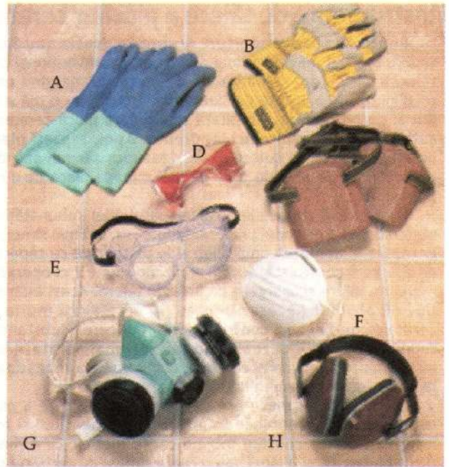
A – mănuși de protecție din cauciuc; B – mănuși de lucru; C – protectoare pentru genunchi (genunchiere); D – ochelari de protecție uzuali; E – ochelari mai mari de protecție; F – mască pentru reținerea particulelor; G – mască pentru a respira într-un mediu cu substanțe toxice; H – protectoare pentru urechi (antifoane)
