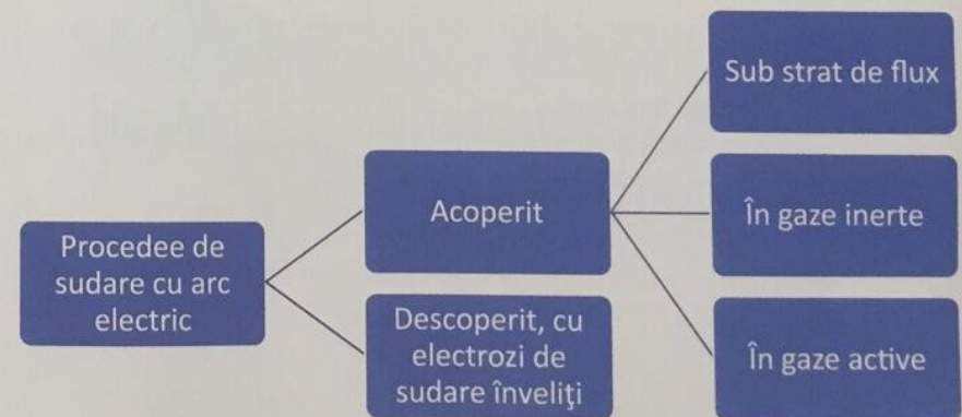
Fig. 1.2. Clasificarea procedeelelor de sudare care utilizează ca sursă termică arcul electric
