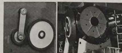
Fig. 6.16. Tipuri de roți de fricțiune: a – cilindrice; b – conice.
