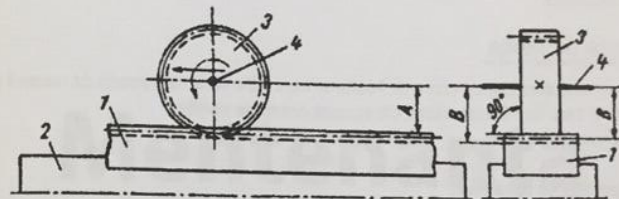
Fig. 7.17. Schema mecanismului roată dințată-cremalieră: 1 - cremalieră; 2 - batiul mașinii; 3 - roata dințată; 4 - axul roții dințate.
