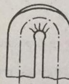
Fig. 4.55. Forma secțiunii în zona de curbură.
