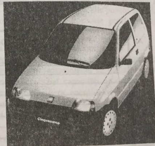
Fig. 2.60. Automobilul electric Cinquecento Elettra , de 9,2 kW, construit de firma Fiat.
