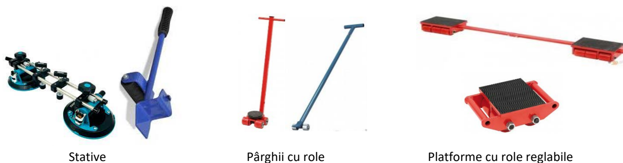
Fig. 32. Alte instalații de ridicare-transportare
