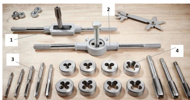
Fig. 176. Set de tarozi și filiere: 1 – porttarozi, 2 – portfiliere; 3 – tarozi; 4 – filiere
