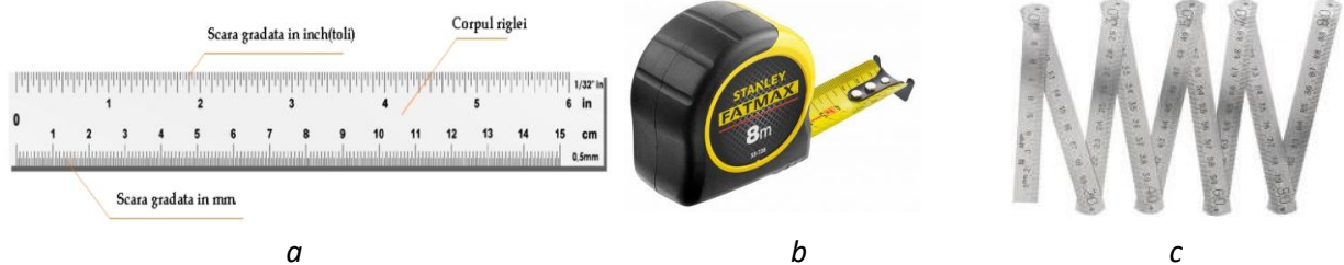
Fig. 88. Rigle gradate: a – rigidă; b – flexibilă; c – metru pliabil flexibil
