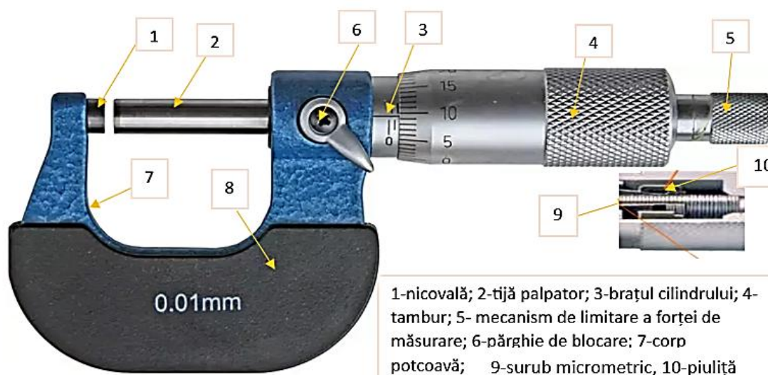
Fig. 93. Micrometru de exterior
