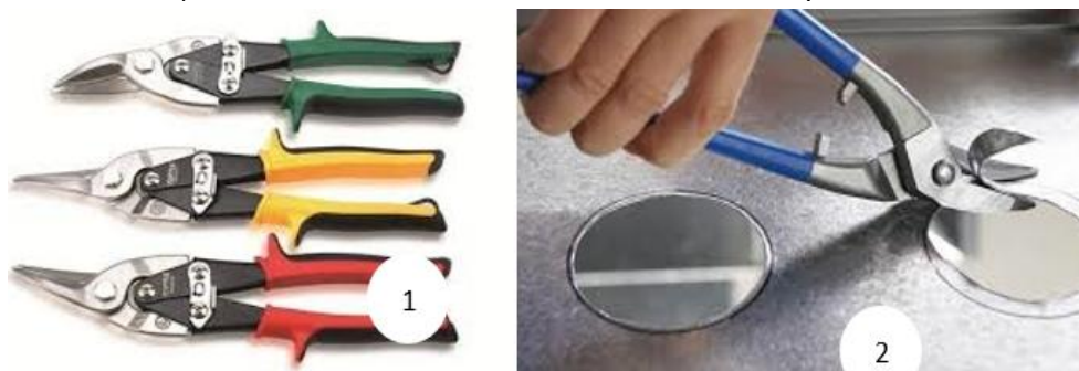
Fig. 124. Foarfecă de mână: 1 – cu tășul drept, 2 – cu tășul curbat
