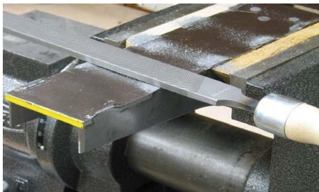
Fig. 142. Fixarea semifabricatului în menghină
