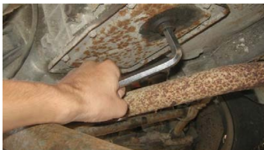
Fig. 58. Scurgerea uleiului din cutia de viteze
