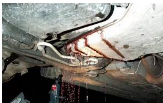
Fig. 44. Scurgerea uleiului din cutia de viteze
