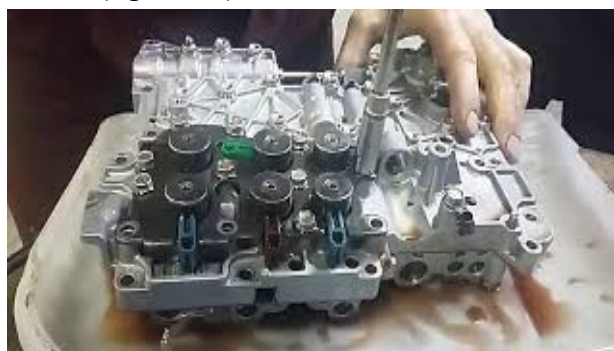
Fig. 91. Restabilirea sau înlocuirea blocului hidraulic
