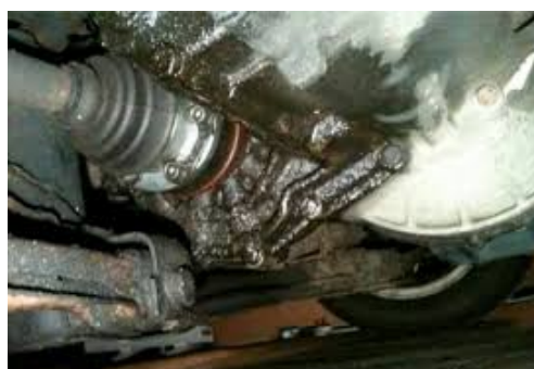
Fig. 44. Scurgerea uleiului din cutia de viteze
