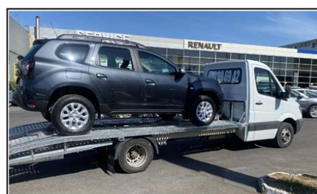
Fig. 149. Tractarea autovehiculului cu tracțiune integrală
