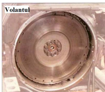
Fig. 52. Existența uleiului pe suprafața volantului
