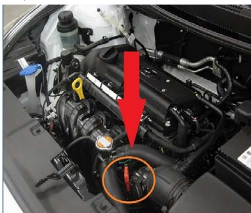
Fig. 97. Verificarea nivelului de fluid în cutia de viteze automată cu tija (joja) de nivel
