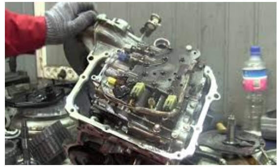
Fig. 92. Asamblarea cutiei de viteze automate
