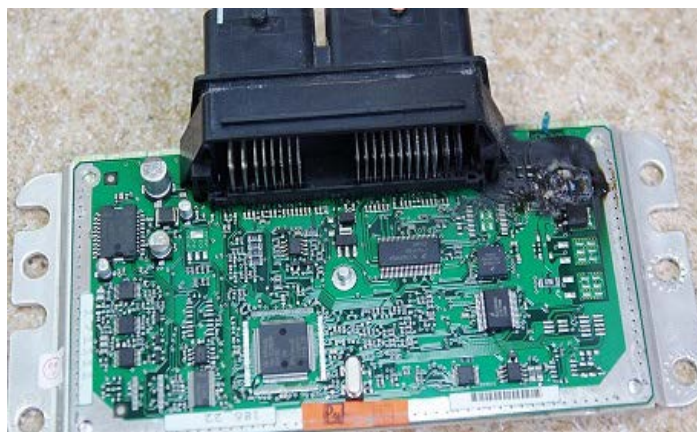
Fig. 86. Unitatea electronică de comandă a cutiei de viteze automate
