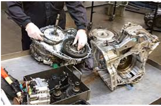
Fig. 92. Asamblarea cutiei de viteze automate
