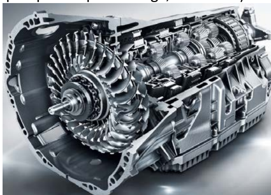
Fig. 61. Cutie de viteze automată cu convertizor de cuplu (hidrotransformator)
