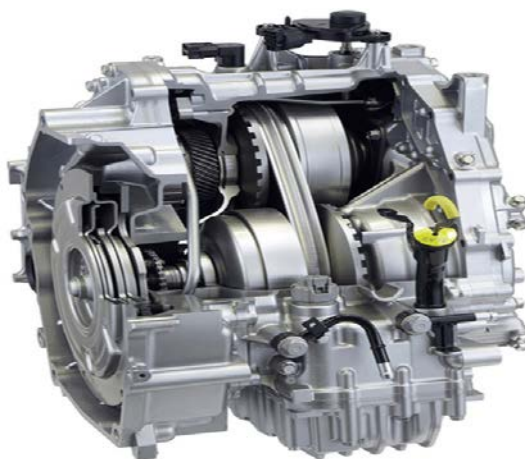
Fig. 62. Cutie de viteze automată cu variație continuă (CVT)
