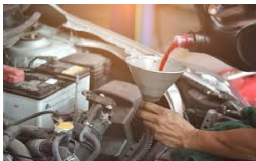
Fig. 59. Alimentarea cu ulei și verificarea nivelului acestuia în cutia de viteze
