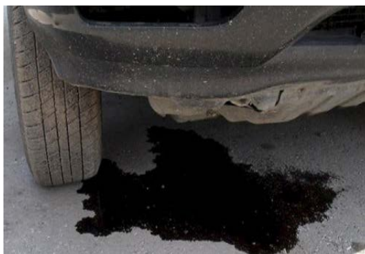
Fig. 79. Scurgeri de ulei din cutia de viteze automată
