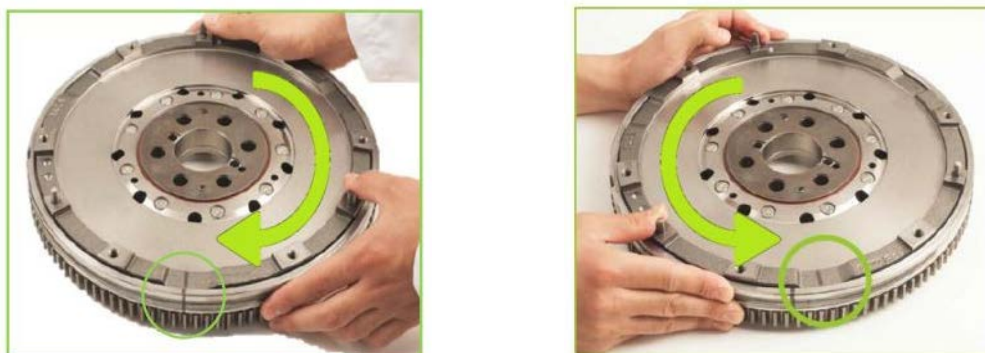
Fig. 17. Testarea unui volant cu masă dublă
