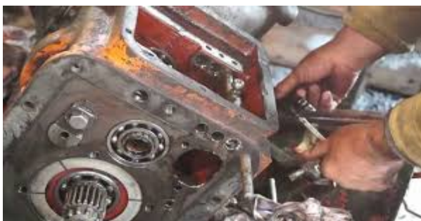
Fig. 89. Demontarea și curățarea componentelor cutiei de viteze
