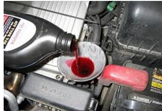
Fig. 93. Umplerea cutiei de viteze cu fluid de transmisie
