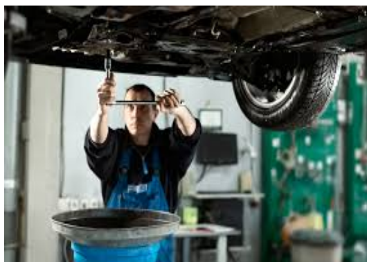
Fig. 99. Înlocuirea fluidului din cutia de viteze automată
