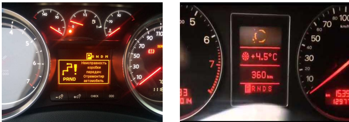
Fig. 95. Panou de bord cu semnalizator de defect
