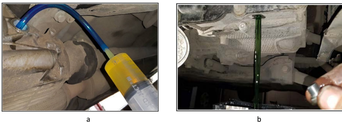
Figura 127. Înlocuirea uleiului din transmisia principală: a – prin aspirare; b – prin scurgere
