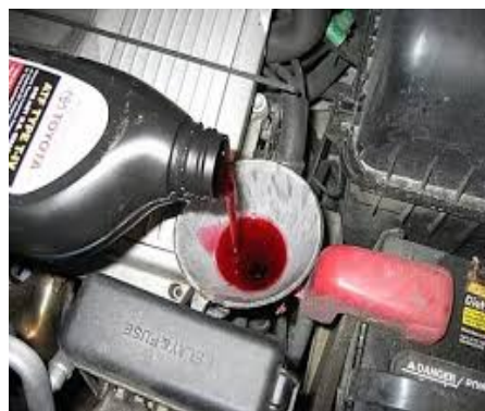
Fig. 99. Înlocuirea fluidului din cutia de viteze automată
