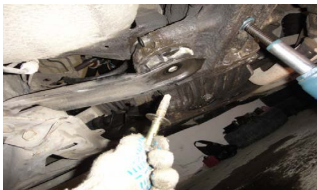
Fig. 45. Scurgerea uleiului din cutia de viteze
