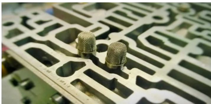
Fig. 85. Bloc de comandă hidraulic
