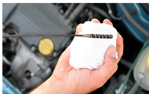
Fig. 59. Alimentarea cu ulei și verificarea nivelului acestuia în cutia de viteze
