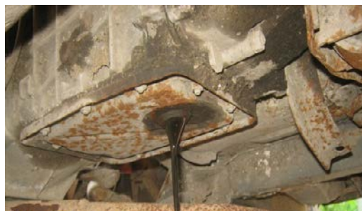
Fig. 58. Scurgerea uleiului din cutia de viteze
