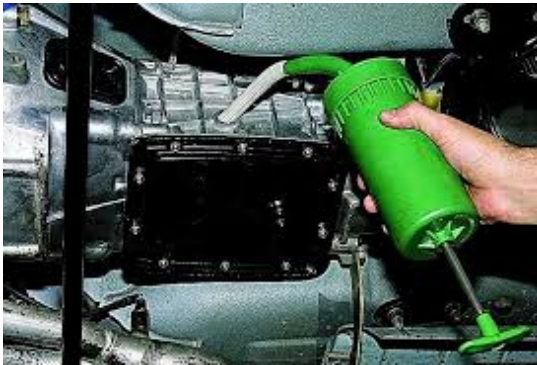
Fig. 93. Umplerea cutiei de viteze cu fluid de transmisie
