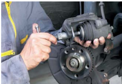
Fig. 147. Aducerea pistonului în poziție de lucru/inițială
