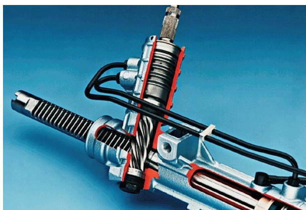
Fig. 17. Servodirecție hidraulică cu pinion și cremalieră: 1 – lichid sub presiune înaltă; 2 – piston; 3 – lichid sub presiune joasă; 4 – pinion; 5 – cremaliera; 6 – distribuitor servodirecției; 7 – coloană de direcție; 8 – pompa servodirecției; 9 – rezervor de lichid; 10 – element de suspendare
