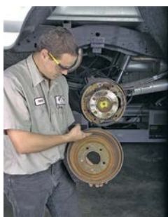
Fig. 127. Verificarea stării suprafeței de lucru a tamburului
