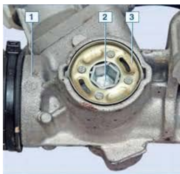
Fig. 48. Reglarea jocului între pinion și cremalieră
