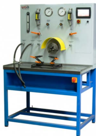
Fig. 61. Stand special de control al pompelor servodirecției
