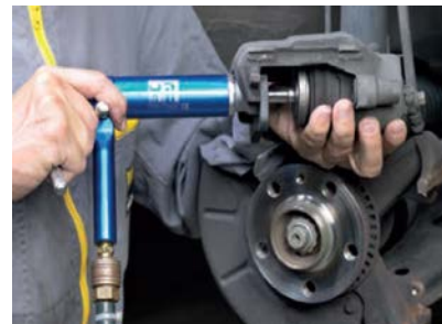
Fig. 147. Aducerea pistonului în poziție de lucru/inițială
