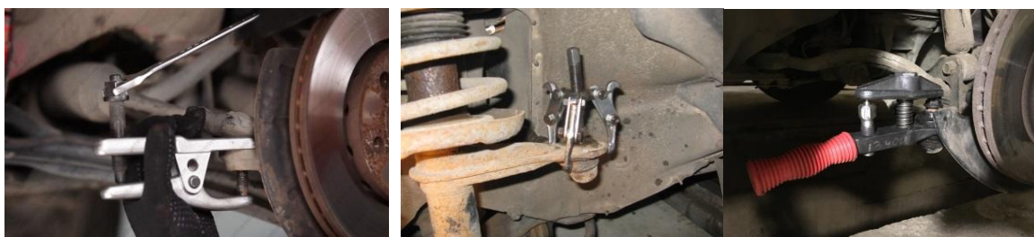
Fig. 53. Depresarea pivotului capului de bară din fuzetă
