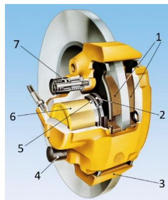
Fig. 75. Frână cu etrier flotant cu știfturi de ghidare: 1 – plăcuțe de frână; 2 – capac de protecție; 3 – suport; 4 – capac protecție/garnitură burduf; 5 – inel de etanșare; 6 – piston, 7 – știft de ghidare
