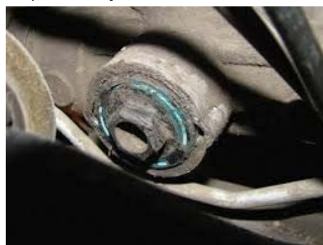
Fig. 48. Reglarea jocului între pinion și cremalieră
