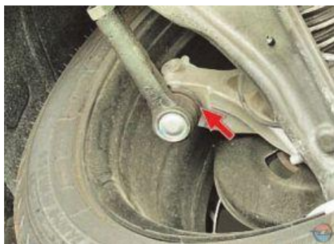
Fig. 43. Verificarea huselor articulațiilor sferice
