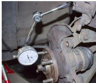
Fig. 140. Verificarea bătaii frontale a flanșei butucului roții
