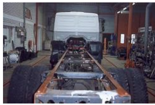
Fig. 81. Cadrul până la reparare și după îndreptare
