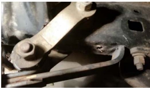
Fig. 46. Defecte ale arcului în foi: a – al doilea arc se sprijină în cadru (motiv de zgomote); b – arc în foi montat corect în locașul său
