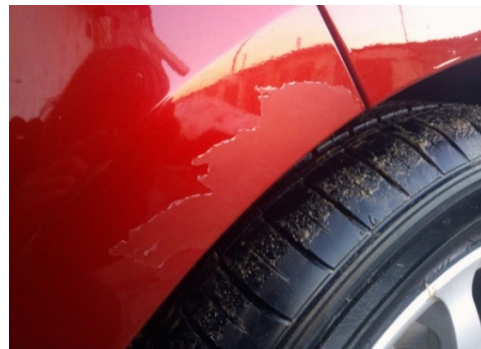
Fig. 85. Efectuarea lucrărilor de întreținere tehnică: a – înlocuirea filtrului pentru habitacul; b – observarea stratului de lac exfoliat
