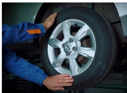
Fig. 26. Verificarea jocului în rulmenți (a), reglajul rulmenților (b, Mercedes W202)
