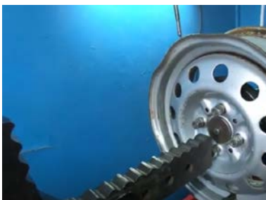
Fig. 113. Discul roții: a – montarea discului pe dispozitiv, b – îndreptarea discului
