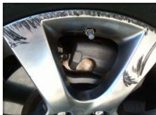
Fig. 111. Defecte ale discului: a – ruptură pe suprafața jantei; b – zgârieturi pe partea laterală a discului
