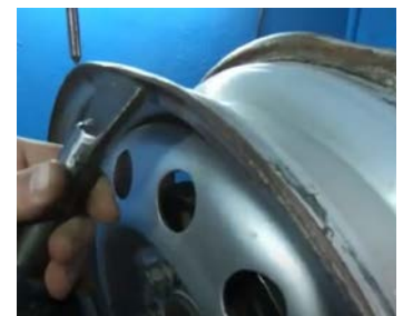
Fig. 113. Discul roții: a – montarea discului pe dispozitiv, b – îndreptarea discului
