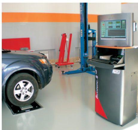
Fig. 53. Diagnosticarea amortizoarelor: a – amplasarea automobilului la stand; b – rezultatele testării amortizoarelor
