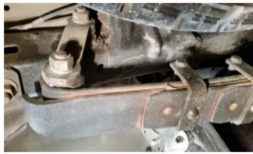
Fig. 46. Defecte ale arcului în foi: a – al doilea arc se sprijină în cadru (motiv de zgomote); b – arc în foi montat corect în locașul său
