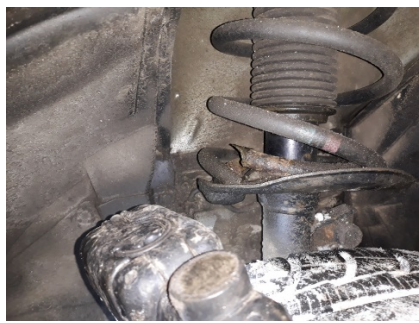
Fig. 47. Defecte ale arcului elicoidal: a – micșorarea rigidității arcului; b – ruperea arcului din partea de jos; c – coroziune și ruperea arcului din partea de jos
