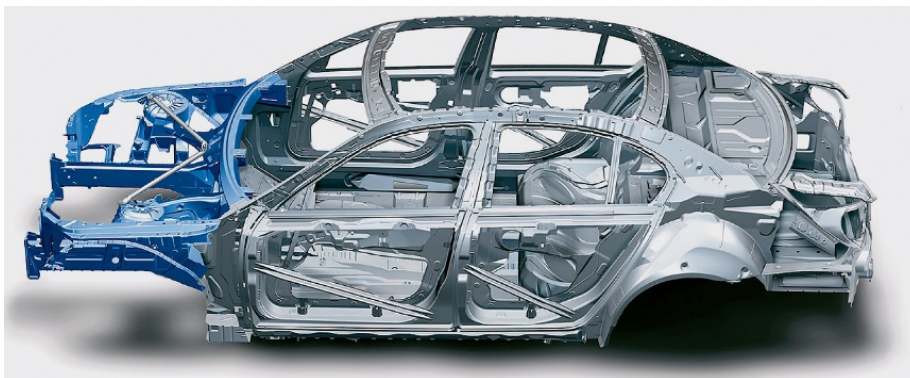
Fig. 70. Elemente ale caroseriei din aliaj de aluminiu
