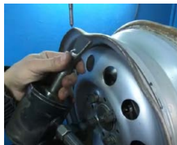
Fig. 113. Discul roții: a – montarea discului pe dispozitiv, b – îndreptarea discului
