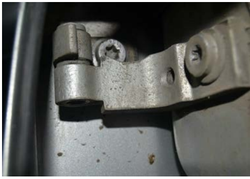
Fig. 84. Verificarea stării tehnice a balamalelor și limitatoarelor portierelor
