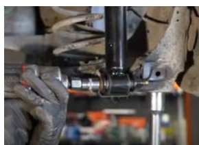
deșurubarea bulonului și a piuliței
