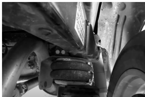
Fig. 20. Perne pneumatice: a – pernă în stare de funcționare; b – pernă defectă
