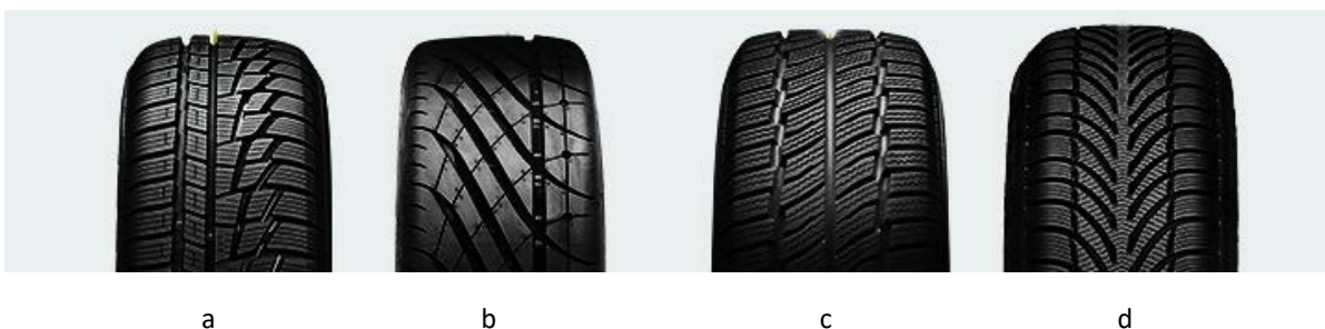
Fig. 98. Anvelope de vară: a – bandă de rulare asimetrică fără direcție de rotație; b – bandă de rulare asimetrică cu direcție de rotație; c – bandă de rulare simetrică fără direcție de rotație; d – bandă de rulare simetrică cu direcție de rotație
