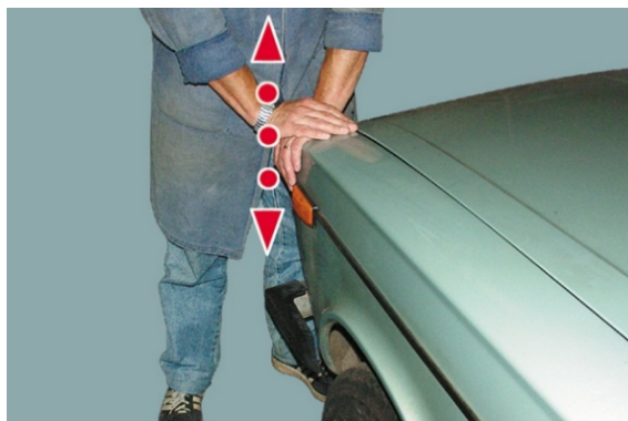
Fig. 52. Verificarea și testarea amortizorului prin apăsare și eliberare a automobilului
