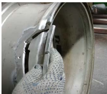
Fig. 111. Defecte ale discului: a – ruptură pe suprafața jantei; b – zgârieturi pe partea laterală a discului
