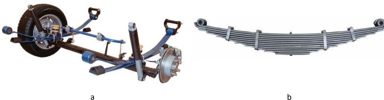
Fig. 33. Arcul în foi montat pe suspensia automobilului (a), arcul în foi separat (b)
