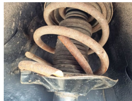
Fig. 47. Defecte ale arcului elicoidal: a – micșorarea rigidității arcului; b – ruperea arcului din partea de jos; c – coroziune și ruperea arcului din partea de jos
