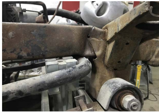
Fig. 78. Prezența deformării și a crăpăturii
