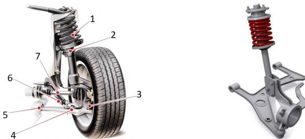
Fig. 10. Suspensie independentă MacPherson: 1 – arc elicoidal, 2 – amortizor, 3 – articulație sferică, 4 – braț oscilant inferior, 5 – locul de fixare a brațului față de grinda caroseriei, 6 – cap de bară, 7 – arborele planetar al transmisiei
