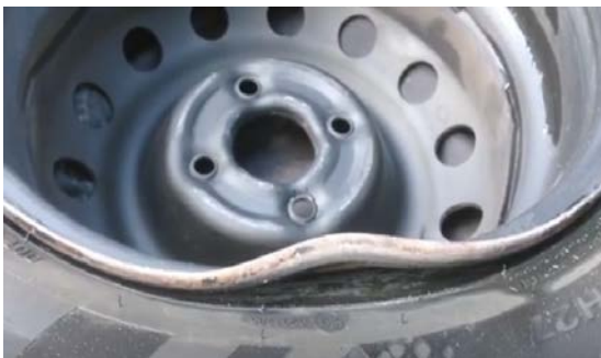
Fig. 112. Roata automobilului: a – disc deformat; b – dejantarea roții
