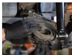
demontarea suportului de cauciuc inferior
