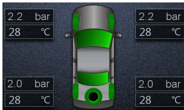
Fig. 107. Exemplu de informații privind presiunea și temperatura pentru fiecare anvelopă a automobilului
