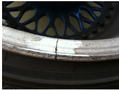
Fig. 109. Prezența crăpăturilor în diverse locuri pe jantă și pe disc
