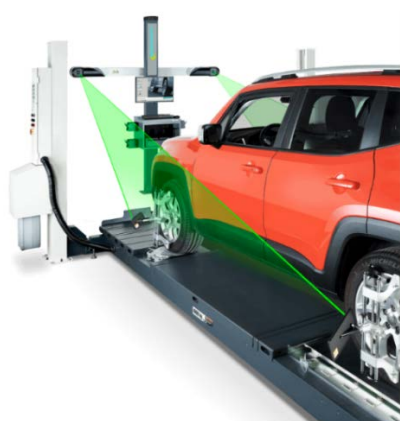
Fig. 122. Post de reglare a geometriei roților: a – instalarea automobilului la post; b – verificarea presiunii din anvelope
