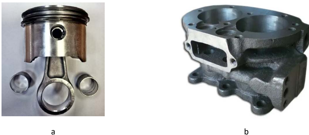
Fig. 21. Elementele componente ale compresorului: a – piston, segmente; b) bloc de cilindri (verificarea gradului de uzare)
