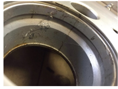
Fig. 109. Prezența crăpăturilor în diverse locuri pe jantă și pe disc
