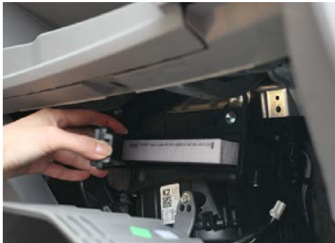
Fig. 85. Efectuarea lucrărilor de întreținere tehnică: a – înlocuirea filtrului pentru habitacul; b – observarea stratului de lac exfoliat
