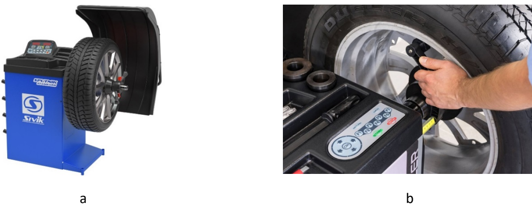
Fig. 103. Stand de balansare: a – montarea roții pe stand; b – introducerea parametrilor
