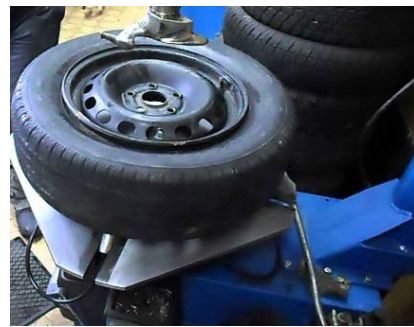
Fig. 112. Roata automobilului: a – disc deformat; b – dejantarea roții
