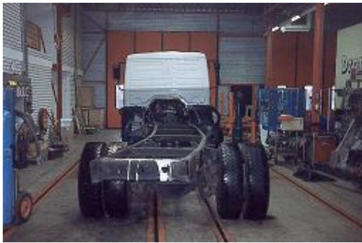
Fig. 81. Cadrul până la reparare și după îndreptare
