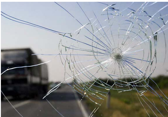
Fig. 83. Verificarea stării elementelor caroseriei: a – parbriz deteriorat; b – verificarea ștergătoarelor de parbriz
