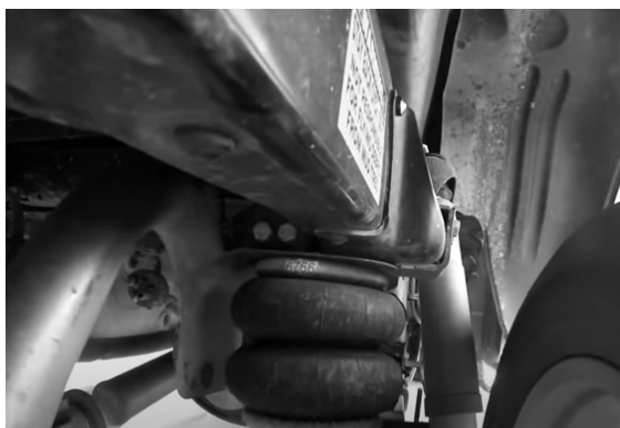
Fig. 20. Perne pneumatice: a – pernă în stare de funcționare; b – pernă defectă
