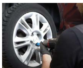
deșurubarea totală a buloanelor
