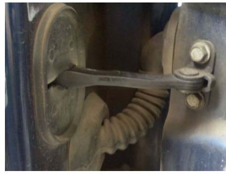
Fig. 84. Verificarea stării tehnice a balamalelor și limitatoarelor portierelor
