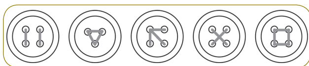
Figura 2.5. Depunerea firului în orificii
